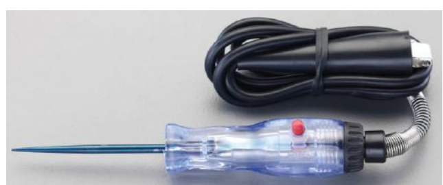
サーキットテスター(ジャンパー対応) 640TA-8 導通チェックだけでなく、クリップを+に 繋げて本体の赤いボタンを押すと機器に 電源を供給出来ます
