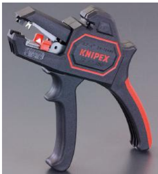
ワイヤー ストリッパー 580KB-11 芯線を傷付ける事無く 自動的に切り込み深さを 調整します 全長160mm
